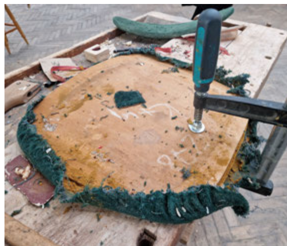
14. 15. 16. Demontaż siedziska krzesła
