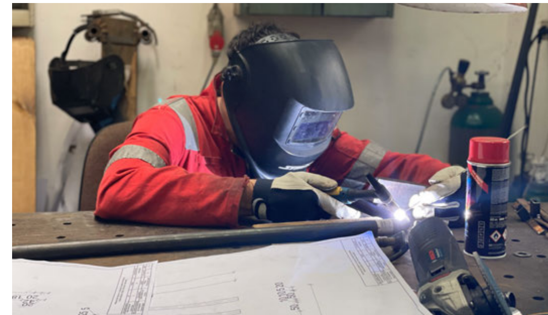
62. Wykonawca spawa elementy prototypu
