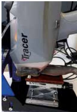
11. Badania szkła przy pomocy P-XRF
